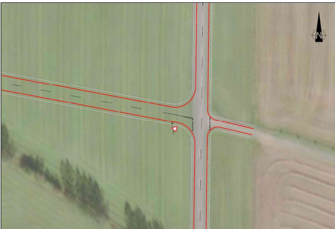
Figur 3.3 Skitse af den omlagte vej med vejtilslutning til Tandskovvej, "Tand_F2_K20_0002".
