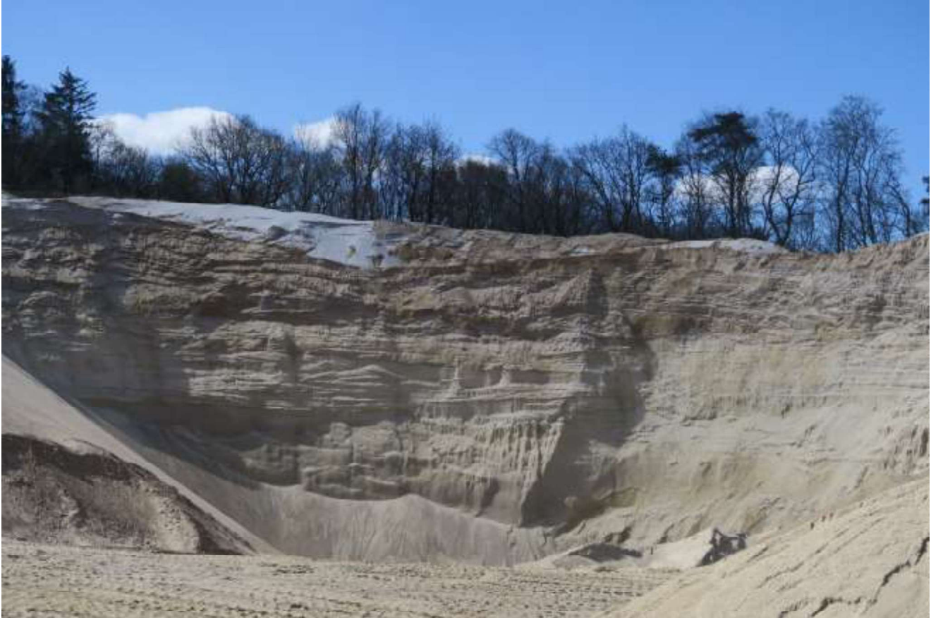
Figur 2.7: Lodrette skrænter ved indvinding over grundvandsspejl i den nuværende råstofgrav. Foto NIRAS, 2021.
