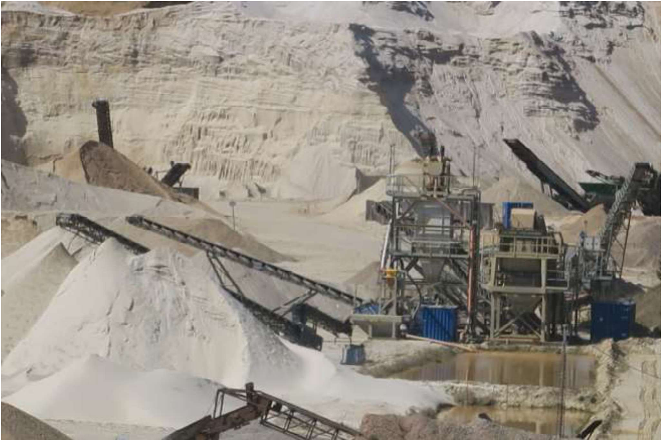
Figur 2.13: Firkantet sedimentationsbassin foran vådsorterer. Foto: NIRAS, 2021
