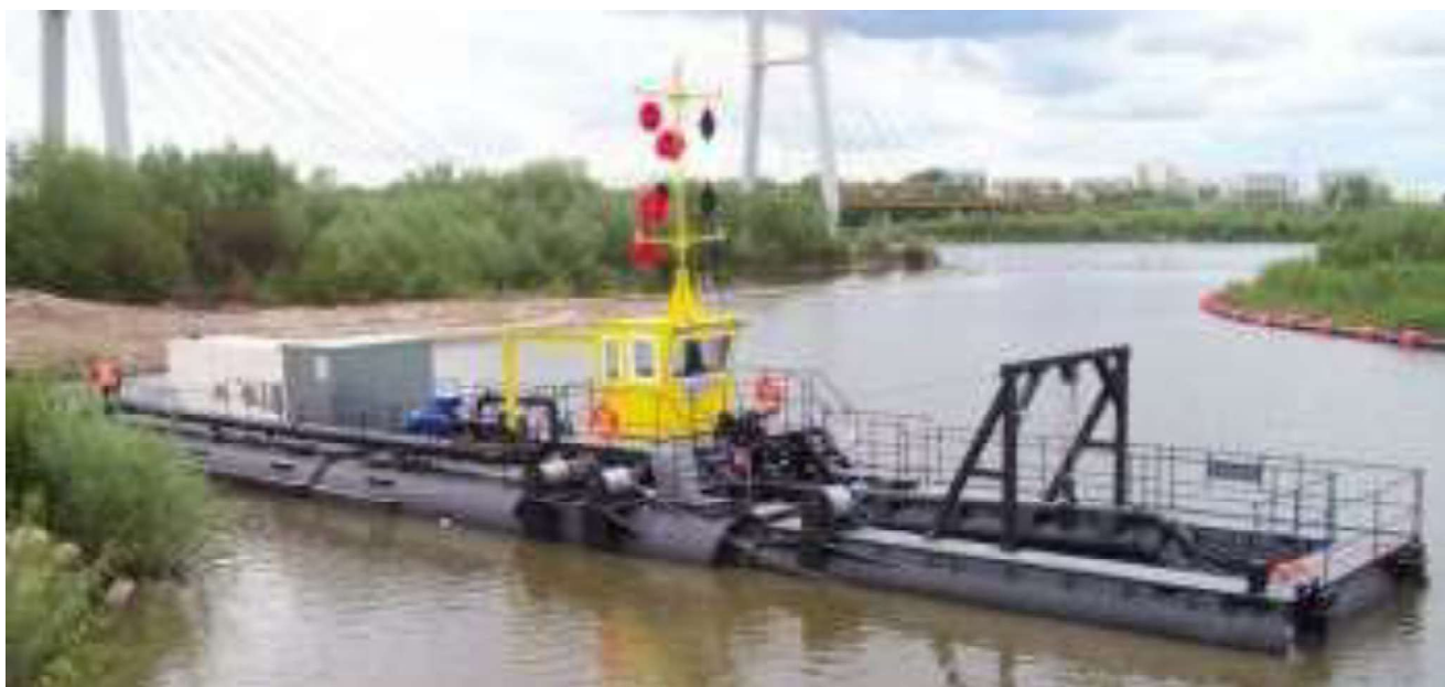
Figur 2.9: Sandsuger, som planlægges indkøbt til råstofindvinding under grundvandsspejl: Foto fra producenten Heinrich Döpke GMBH.
