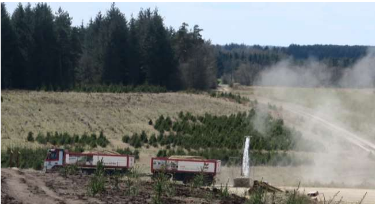
Figur 4.13: Vandingsanlæg til lastbillæs. Vandsøjlen ses lige til højre for lastbilerne.
