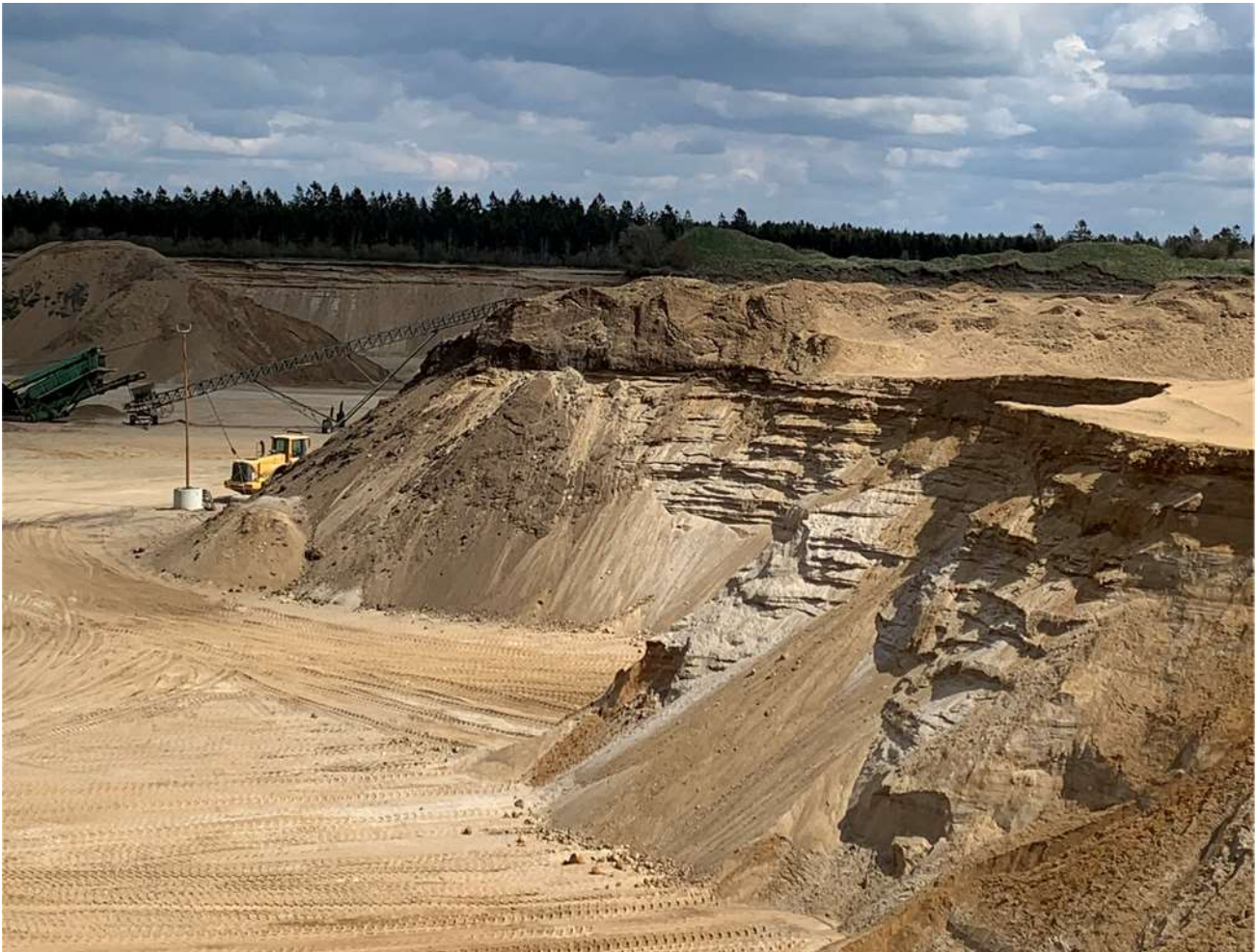
Figur 4.4: Naturlige skredvinkler på 1:1,5 ved indvinding langs graveskrænten i den nuværende råstofgrav.
