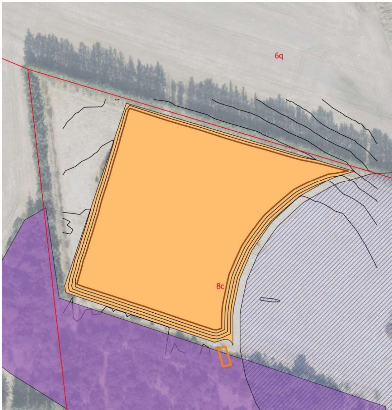
Figur 9: Tørgravning i Område 1 Graveområdet er 3 meter fra skel. Mod beskyttet dige (orange), beskyttet hede (violet) og beskyttelseszonen omkring gravhøjen (skraveret) er der 5m's afstand. Skræntfoden ved skrænthældning 1:2 er vist med brun. Højdekurver er 1 m ækvidistance.
