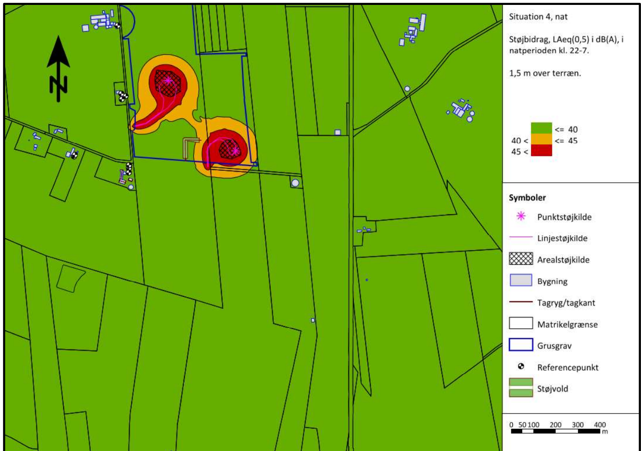
Figur 11: Situation 4. Beregnede støjbidrag, L_{Aeq(0,5)} i dB(A), i natperioden
