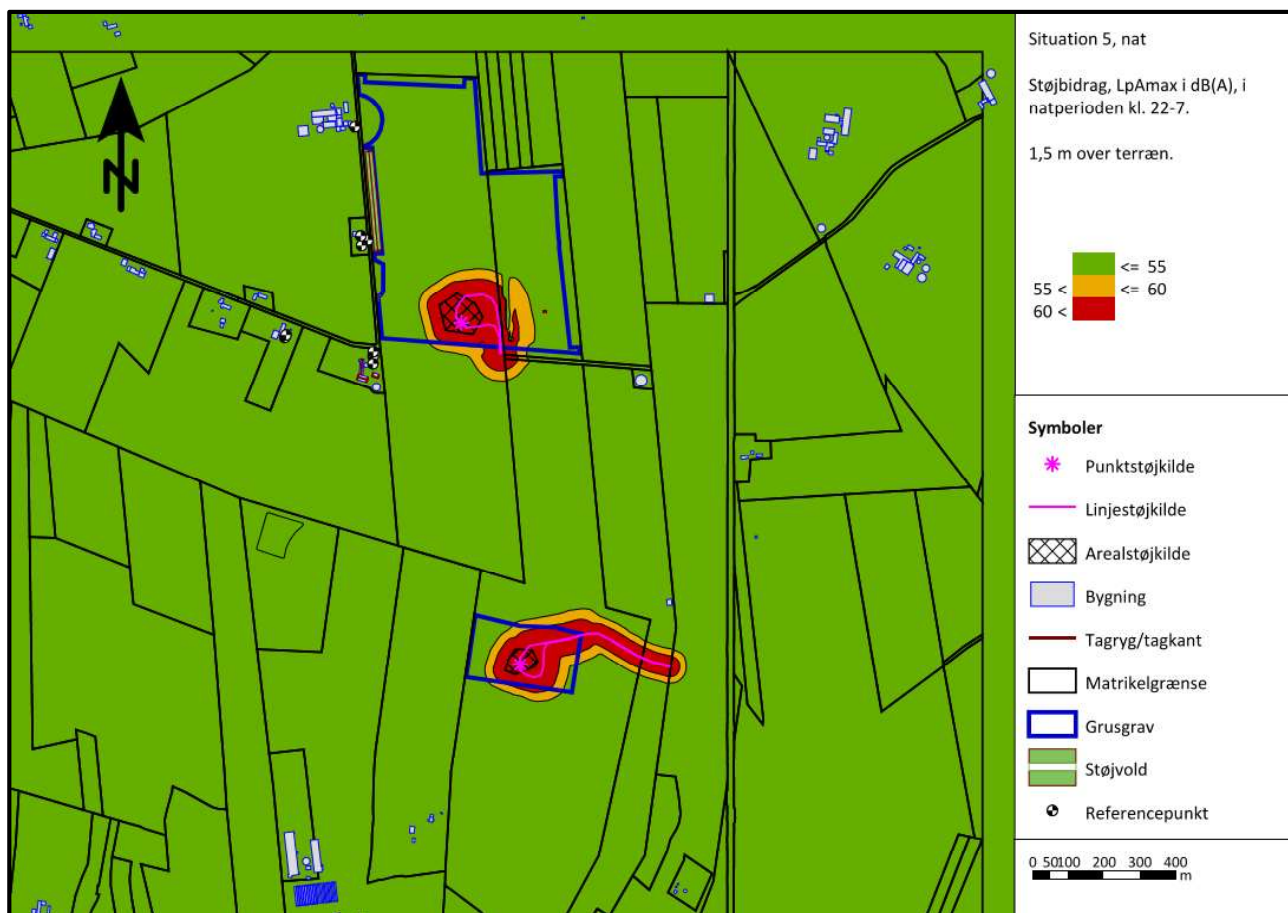
Figur 18: Situation 5. Beregnede støjbidrag, L_{pAmax} i dB(A), i natperioden
