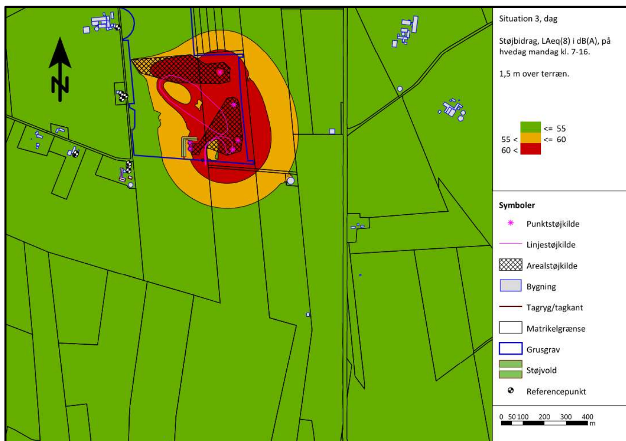
Figur 7: Situation 3. Beregnede støjbidrag, L_{Aeq(8)} i dB(A), i dagperioden
