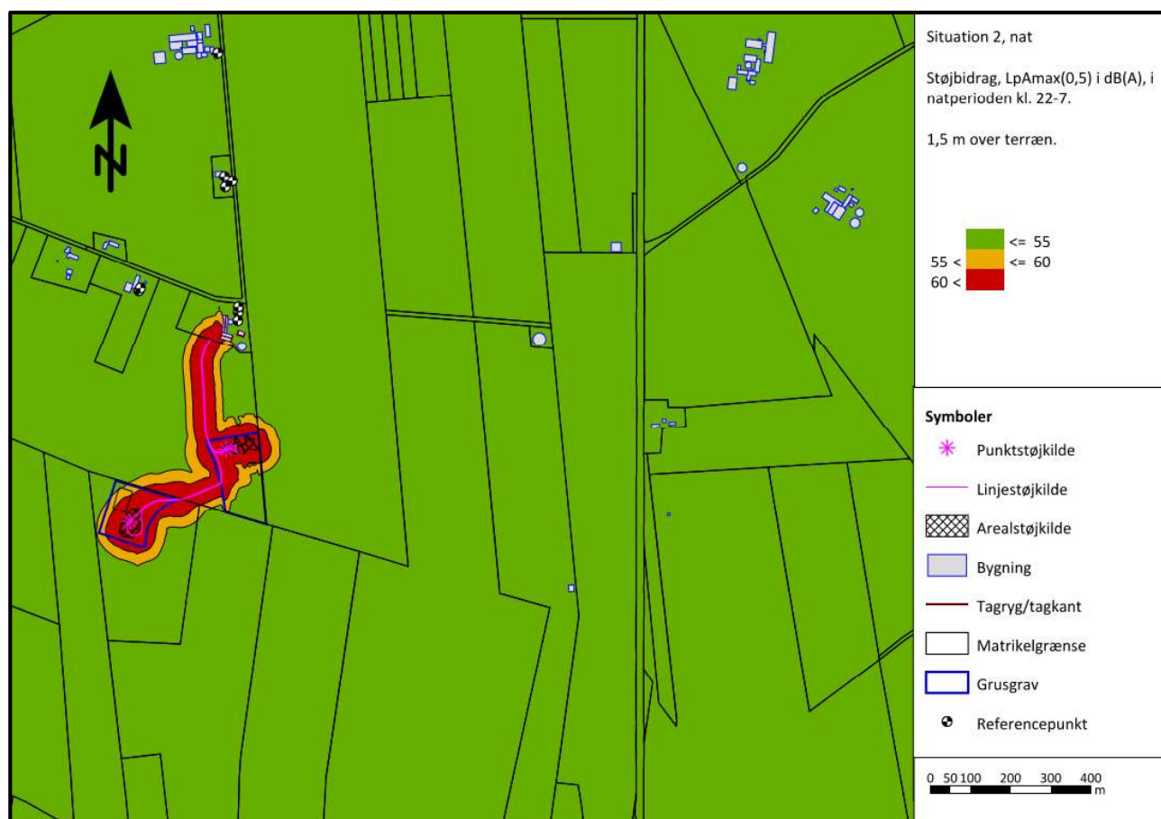
Figur 6: Situation 2. Beregnede støjbidrag, L_{pAmax} i dB(A), i natperioden
