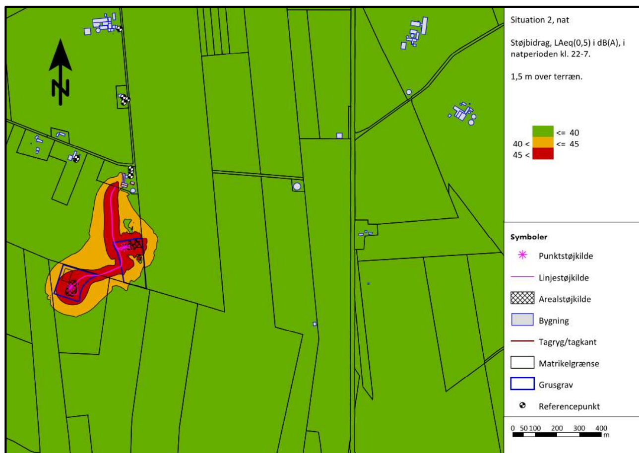
Figur 5: Situation 2. Beregnede støjbidrag, L_{Aeq(0,5)} i dB(A), i natperioden
