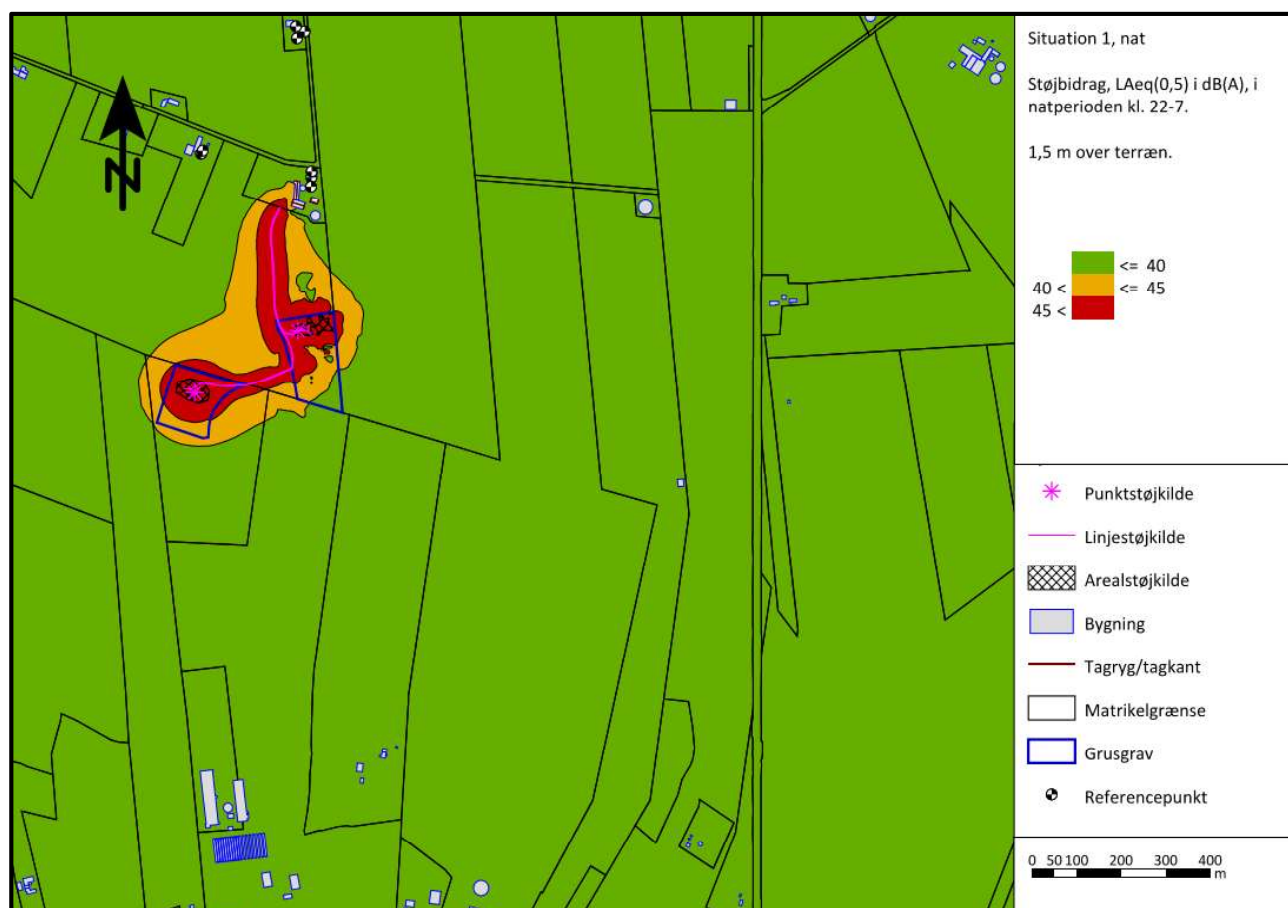
Figur 2: Situation 1. Beregnede støjbidrag, L_{Aeq(0,5)} i dB(A), i natperioden
