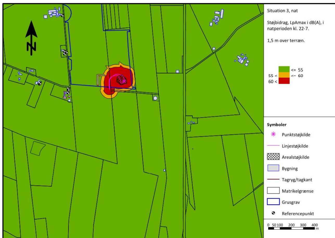
Figur 9: Situation 3. Beregnede støjbidrag, L_{pAmax} i dB(A), i natperioden
