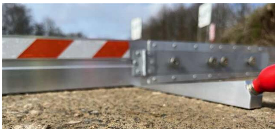
Figur 25 Måling af sporkøring med 4 m rethold.
