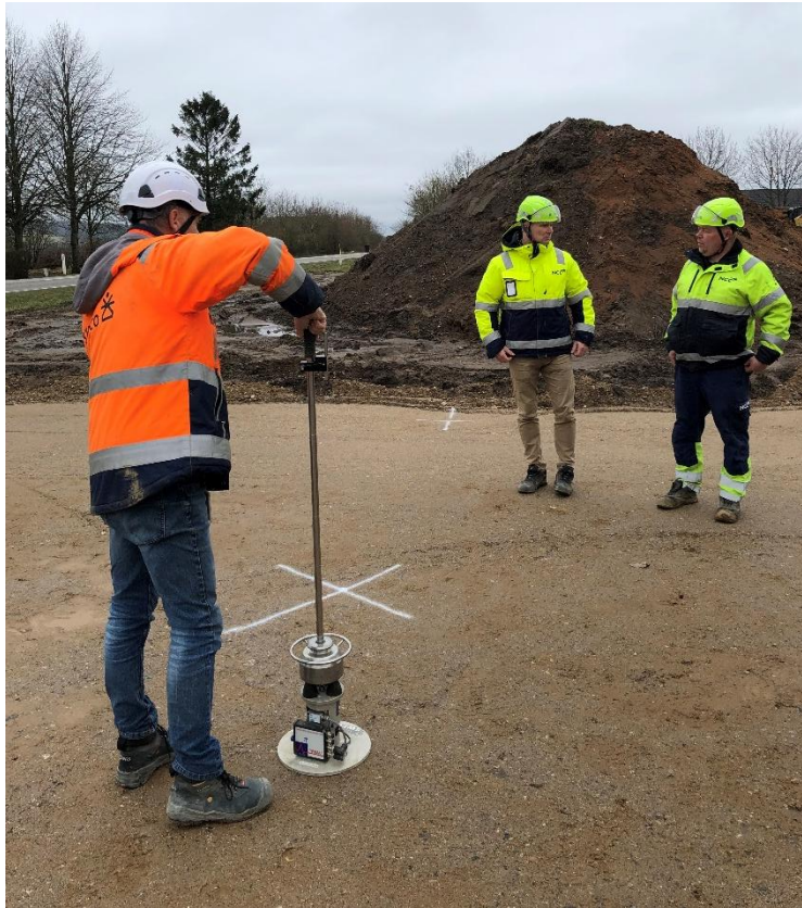
Figur 7. Der måles med let faldlod på overfladen af det indbyggede SG II lag.
