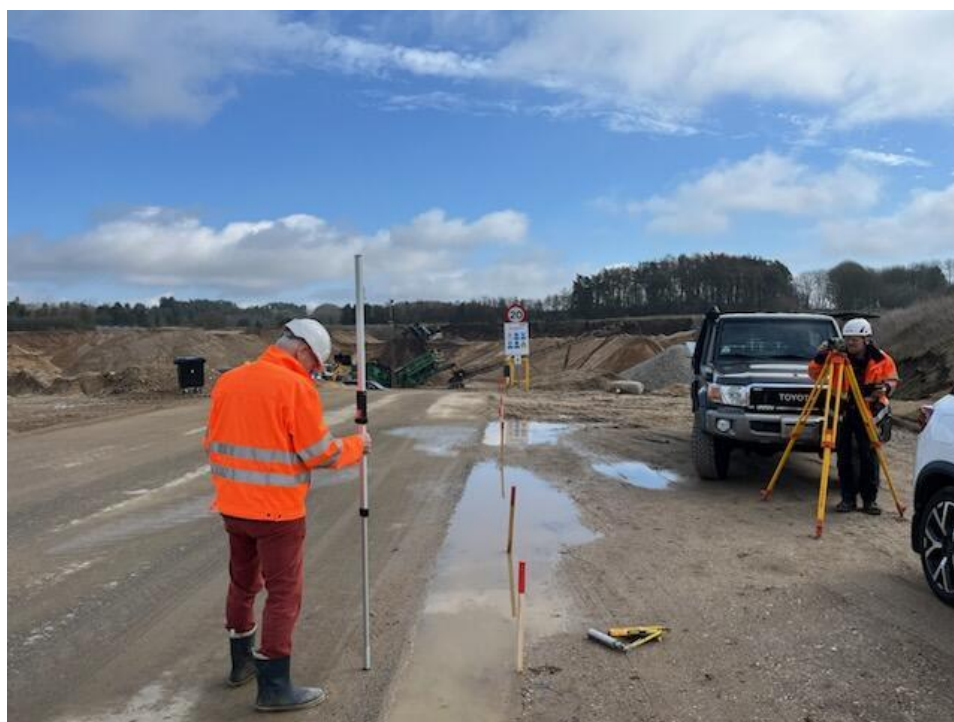
Figur 24 Måling af sporkøring med teodolit.
