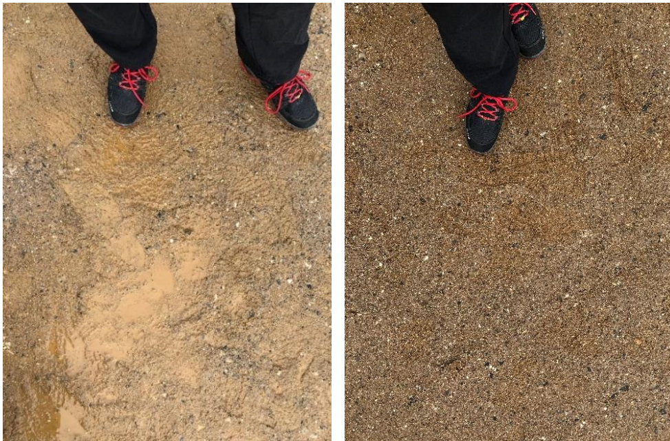
Figur 10. Til venstre ses overfladen af SG II efter to dage med regn. Til højre ses overfladen af Nyt Stabilt Grus efter to dage med regn – fotos taget den 31. marts 2023.
