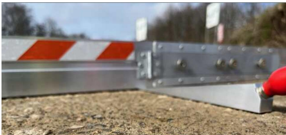
Figur 25 Måling af sporkøring med 4 m rethold.
