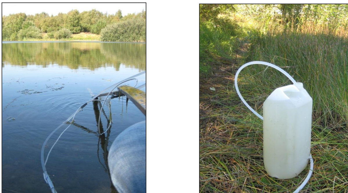
Figur 2-20: Prøvetagningsmetodik fra søbredden. Whale-pumpe monteret for enden af stadiet (foto til venstre) hæves fra bunden af søen til vandoverflade, mens vandet pumpes til beholder (foto til højre).
