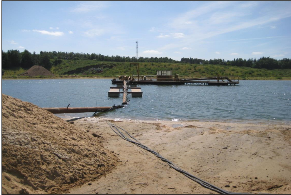
Figur 2-9: Sandsuger. Bunken til venstre på fotoet er materiale, som er indpumpet fra sandsuger- ren.
