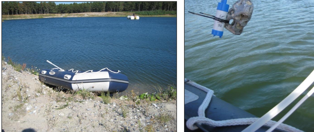
Figur 2-19: Prøvetagningsfartøj (foto til venstre) og whale-pumpe med påmonteret vægt (foto til højre).
