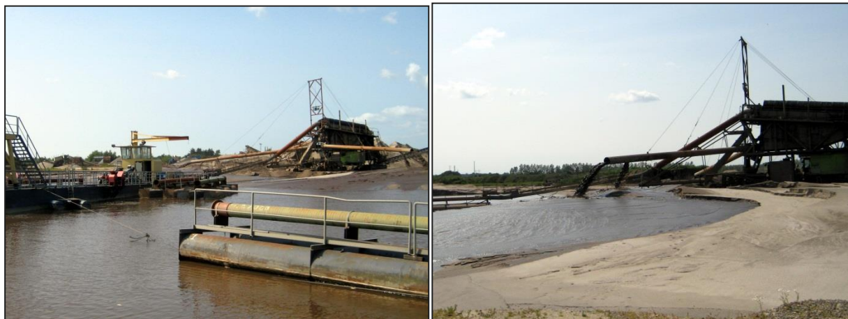
Figur 2-23: Foto til venstre: Indvindingsfartøj til venstre i billedet. Til højre ses sorteringsanlægget. Foto til højre: Sorteringsanlæg med udløb af vand og finkornet sediment (mørkfarver vandet).
