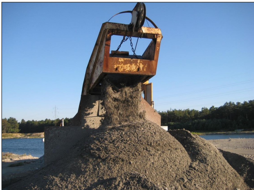
Figur 2-16: Tømning af skovl fra slæbeskovlsspil.
