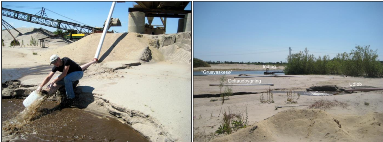
Figur 2-26: Foto til venstre: Prøvetagning ved udløbet fra sorteringsanlæg, der producerer faldsand (prøven "Udløb 3"). Foto til højre: Deltaudbygning fra udløbet af sorteringsanlægget. Indtaget til sorteringsanlægget ses i baggrunden.
