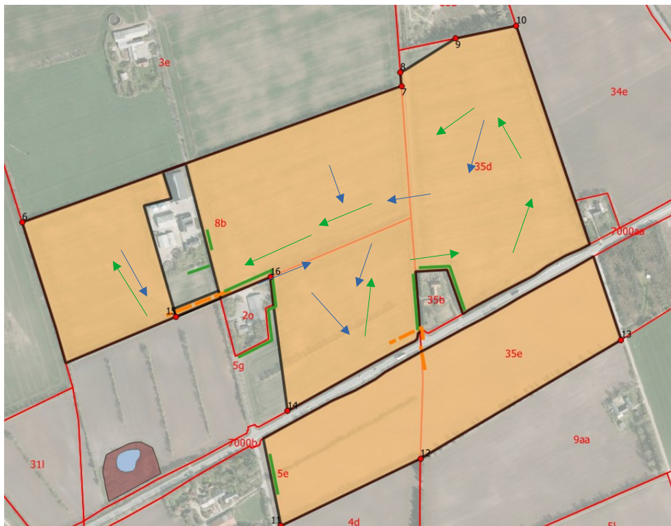
Figur 5: Grønne pile er tørgravning over grundvandsspejlet. Blå er vådgravning under grundvandsspejlet. Grøn prik er sorteranlæg, blå vaskeanlæg.
