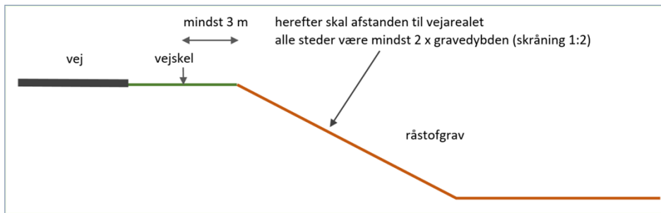
Figur 4. Principskitse for udgravning nær offentlig vej og privat fællesvej uden særskilt tilladelse fra vejmyndigheden.
