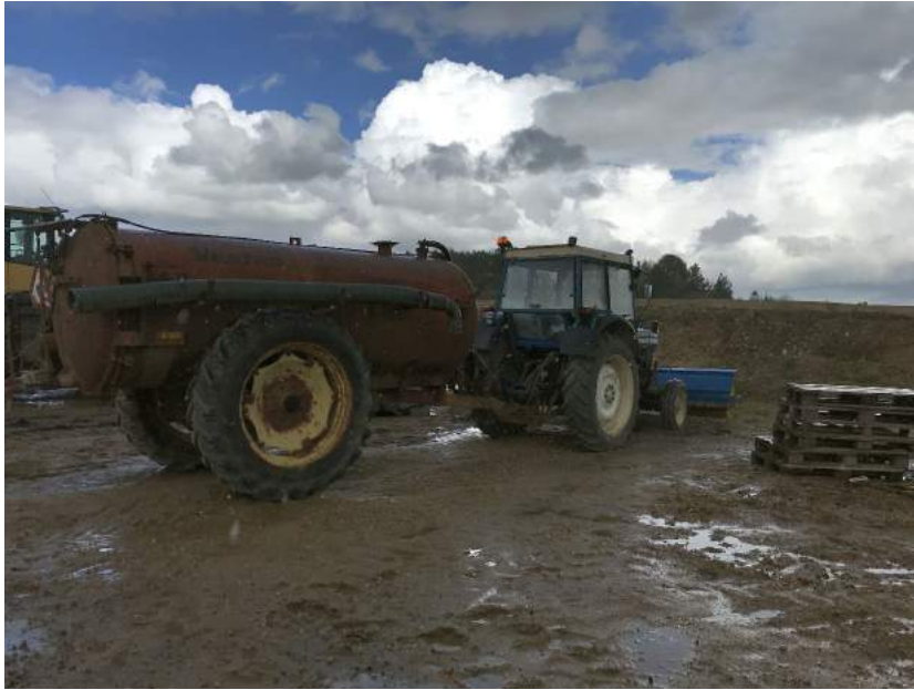
Figur 2: Traktor og slamsuger til sprinkling og fejning
