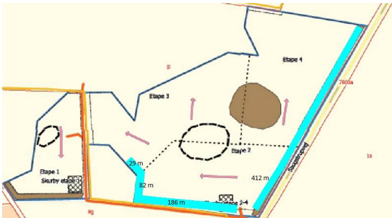
Figur 6: OBS: placeringen af støjvoldene er som ved etape 2. Støjvold for etape 3 og 4 er identiske. Støjvoldene er markeret med turkis farve og langs Saugstrupvej er volden 412 meter lang og 6,0 meter høj. Mod syd er støjvoldene 7 meter høj mod syd og længderne er hhv. 29 meter, 82 meter og 186 meter, som vist på figuren.
