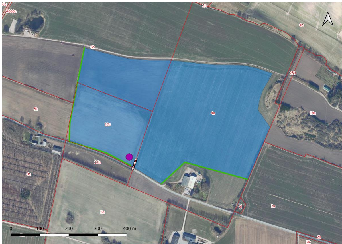
Figur 1.1. Oversigtskort over det ansøgte område, der ses med blå skravering. Den sort-hvid stiplede linje angiver adgangsvejen til råstofgraven. Den violette cirkel angiver placering af mandskabsfaciliteter, mens de grønne streger angiver placering af støjvolde. Matrikelgrænserne er angivet med rød streg.
