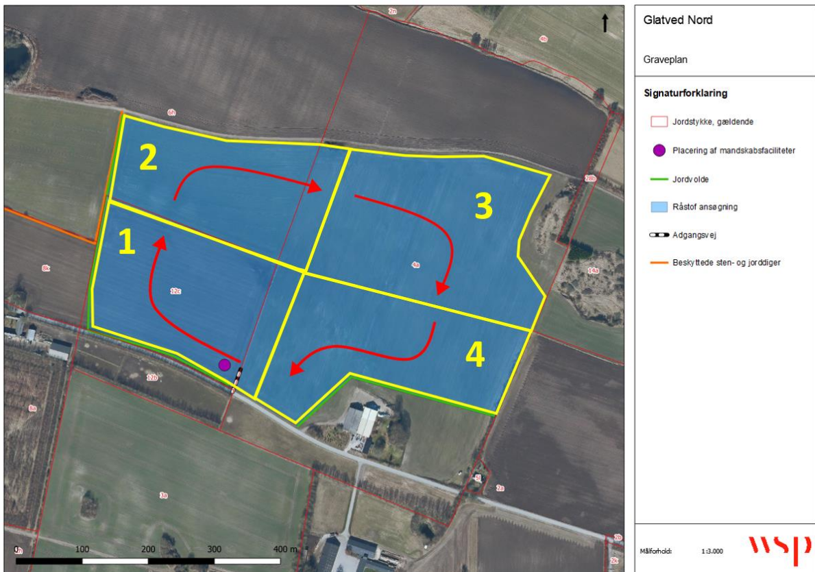
Figur 2.1. Graveplan for det ansøgte område. De gule felter viser de 4 indvindingsetaper. De røde pile angiver graveretningen, hvor det ses, at der vil blive gravet med uret i forbindelse med de 4 etaper.
