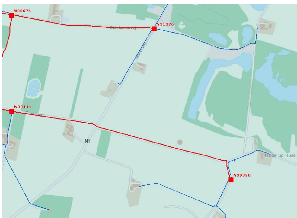
Figur 4: Strømkabler. Rød 10/20 kV, blå 0,4 kV.
