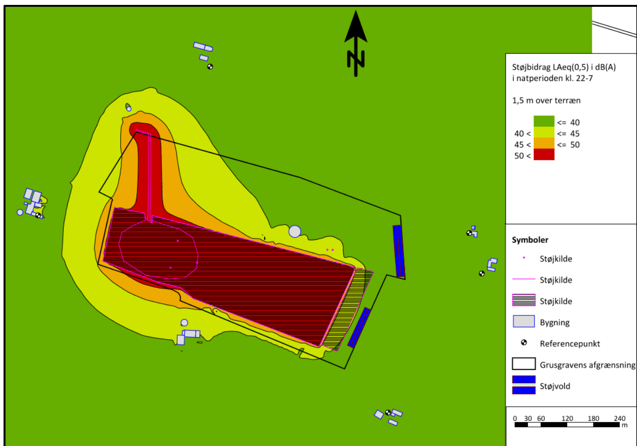
Figur 10: Tørgravning på etape 2 og vådgravning på etape 1. Beregnede støjbidrag, L_{Aeq(0,5)} i dB(A), i natperioden.
