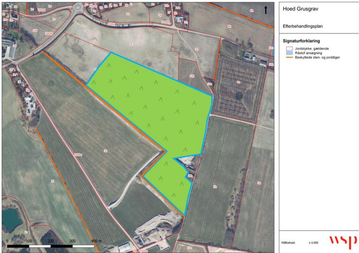
Figur 3.1. Efterbehandlingsplan for det ansøgte område, hvor der er givet dispensation til modtagelse af ren jord efter jordforureningslovens § 52. Der vil blive efterbehandlet til jordbrugsmæssig drift, hvor jorden vil blive lagt ud så området kan blive efterbehandlet til det oprindelige terræn (kote 28-31 DVR90).
