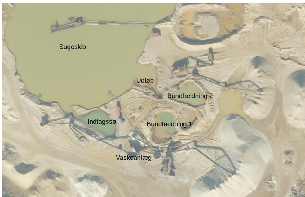
Figur 5: Indretning af grusvaskeanlæg
