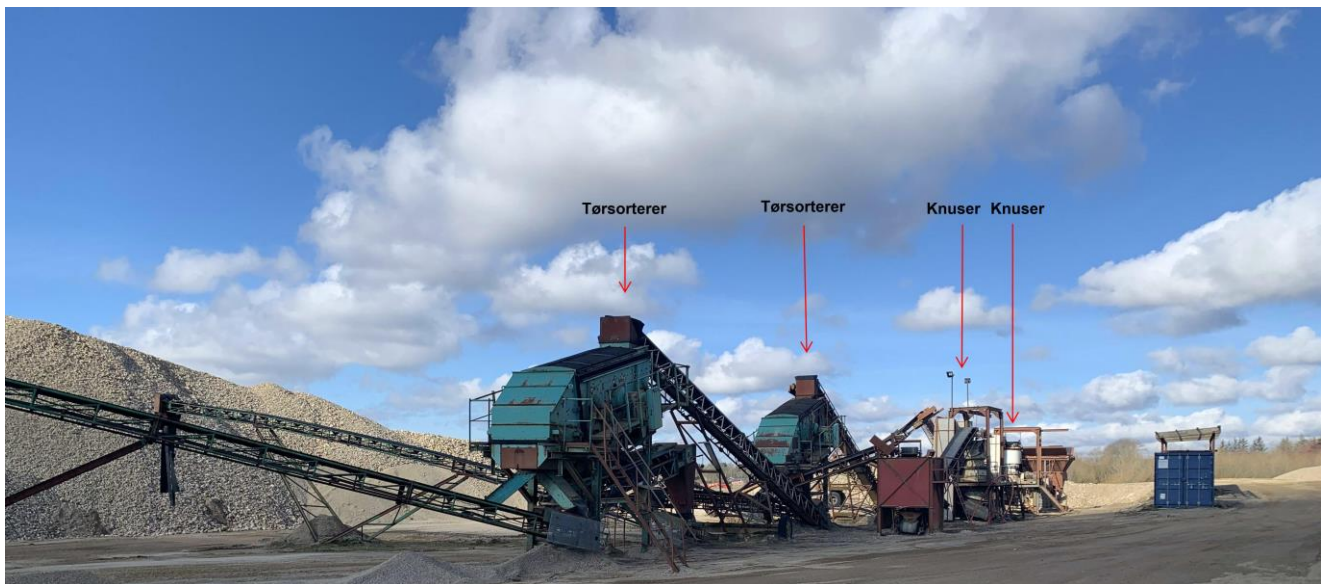
Figur 4.11: 1 Spindelknuser, 1 kegleknuser samt 2 tørsortere. Foto: NIRAS, 9. maj 2022.
