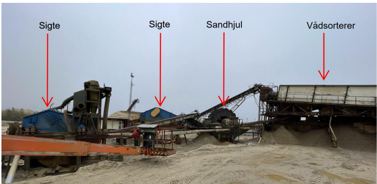
Figur 4.9: Stationær vådsorterer med sandhjul og 2 sigter.. Foto: NIRAS, 26. oktober 2022.
