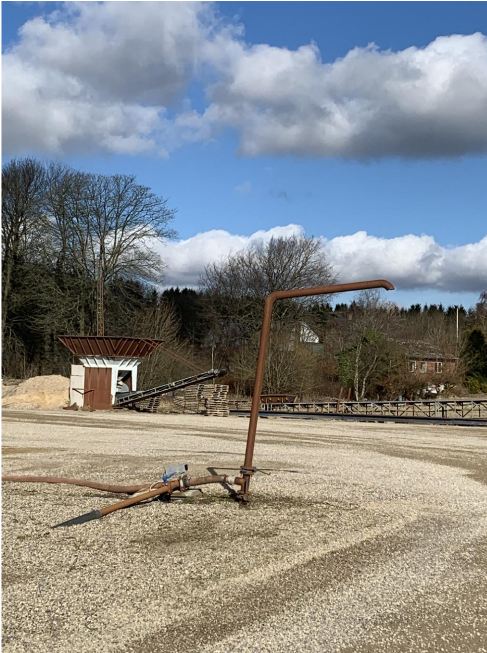
Figur 10.2:: Sprinkler til vanding af lastbilernes lad ved udkørsel fra grusgraven for at dæmpe støv fra lastbillæssene. Foto: NIRAS, 9. maj 2022.
