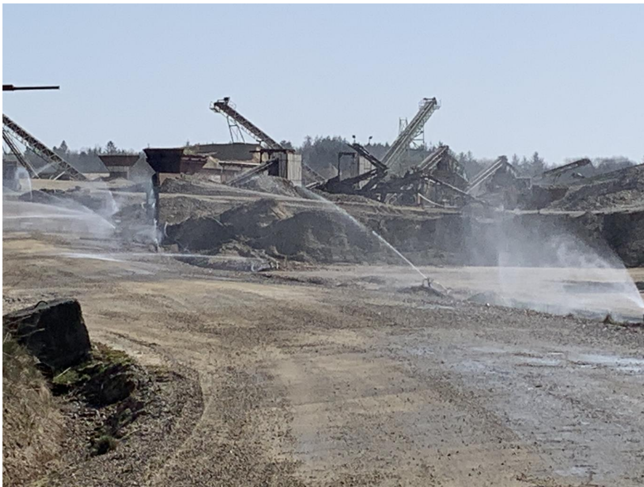
Figur 4.14: Sprinkleranlæg for vanding af adgangsvej. Foto: NIRAS, 9. maj 2022.
