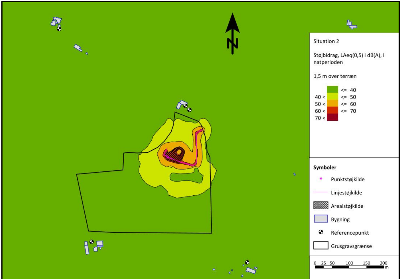
Figur 7: Situation 2. Beregnede støjbidrag, L_{Aeq}(0,5) i dB(A), i natperioden på hverdag i højden 1,5 m over terræn. Støjgrænsen er 40 dB(A).
