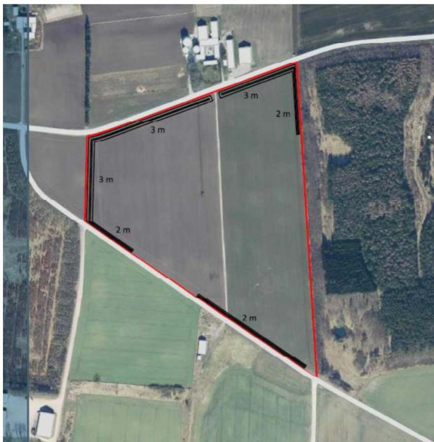
Figur 3. Placering og højder for støjvolde jf. støjberegningerne i bilag B.1. Støjvoldene er vist med sort signatur mens det ansøgte område er vist med rød streg.
