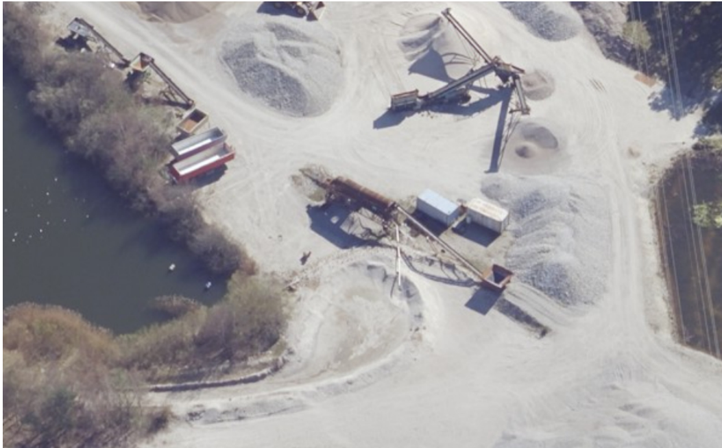
Figur 1. Skråfoto fra grusgraven, der viser vådsorteringsanlægget i midten.
