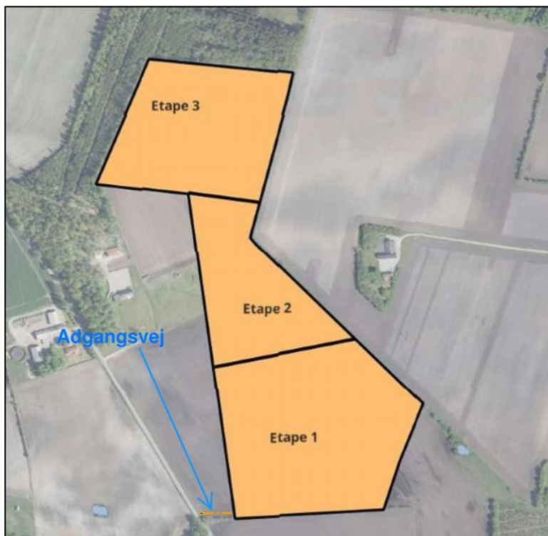
Figur 3.1: Grusgravens areal, adgangsforshold og etapeinddeling
