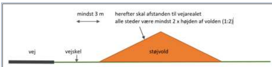
Figur 2. Principskitse for påfyldning nær offentlig vej og privat fællesvej uden særskilt tilladelse fra vejmyndigheden.
