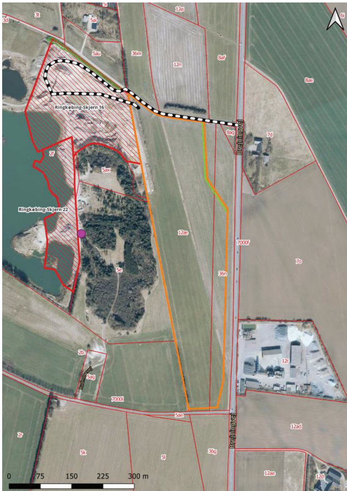
Figur 1.1. Oversigtskort over det ansøgte areal, der ses med orange streg. Indvindingsarealet for de aktive råstofindvindingsstilladelser, ses med tyk rød streg. Den sort-hvide stiplede linje i nord angiver adgangsvejen til råstofgraven. Den violette cirkel angiver placering af oparbejdningsanlæggene, mens de grønne streger angiver placering af jordvolde. Matrikelgrænserne er angivet med tynd rød streg.
