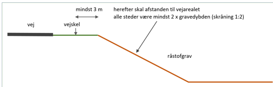
Figur 2. Principkitse for udgravning nær offentlig vej og privat fællesvej uden særskilt tilladelse fra vejmyndigheden.
