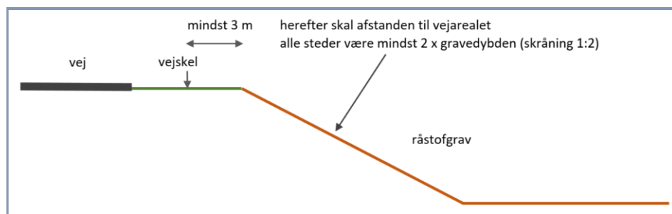
Figur 2. Principskitse for udgravning nær offentlig vej og privat fællesvej uden særskilt tilladelse fra vejmyndigheden.
