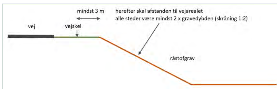
Figur 1. Principskitse for udgravning nær offentlig vej og privat fællesvej uden særskilt tilladelse fra vejmyndigheden.
