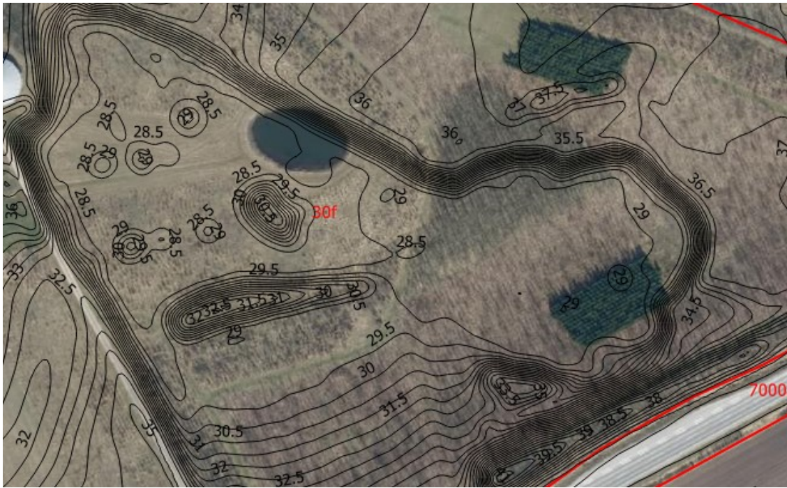
Figur 20: Grundvandsfødte gravesøer på 30f har grundvandsspejl i kote 28,5, lige vest for den nuværende grusgrav .
