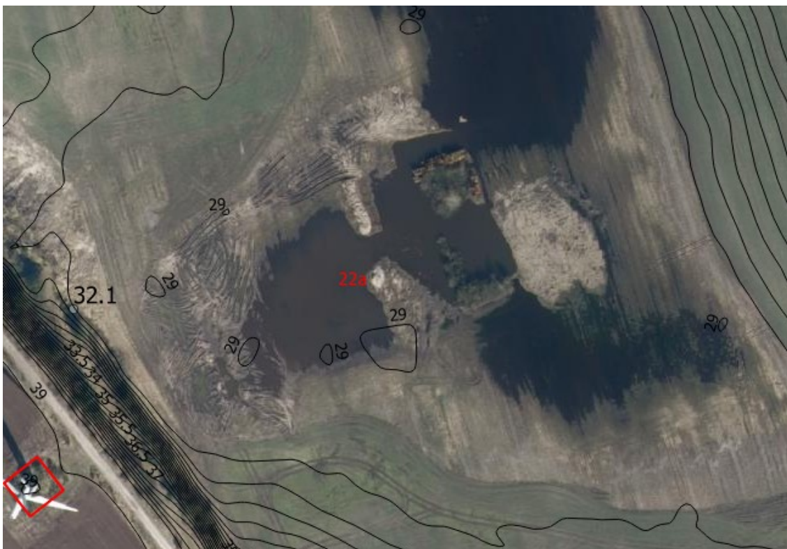
Figur 21: Grundvandsfødte gravesøer på 22a har vandspejl i kote ca. 29 m DVR, lige vest for Område 2 - det nordøstlige område
